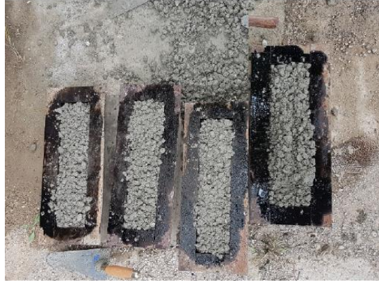
Fig.B.3. Moules remplis du béton pour la gâchée de rapport E/C=0,4 .
