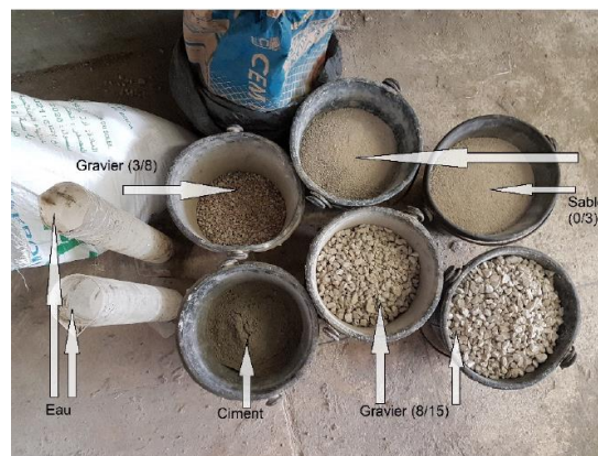
Fig.B.2. Constituants du béton après pesée pour le rapport E/C=0,4.
