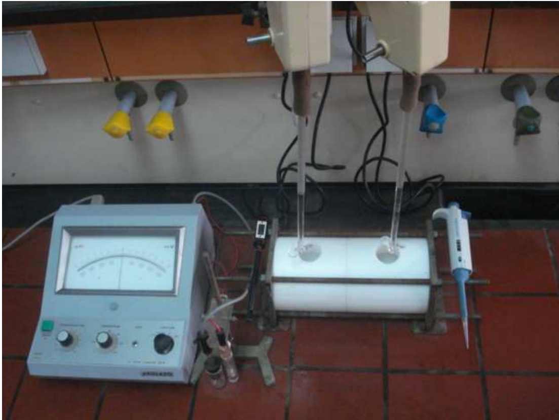
Figure-III.1 : Photo de cellule de transport
