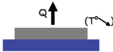
Figure –I.3 : Flux de chaleur Q accompagnant un abaissement de température lors d'une précipitation thermique.
