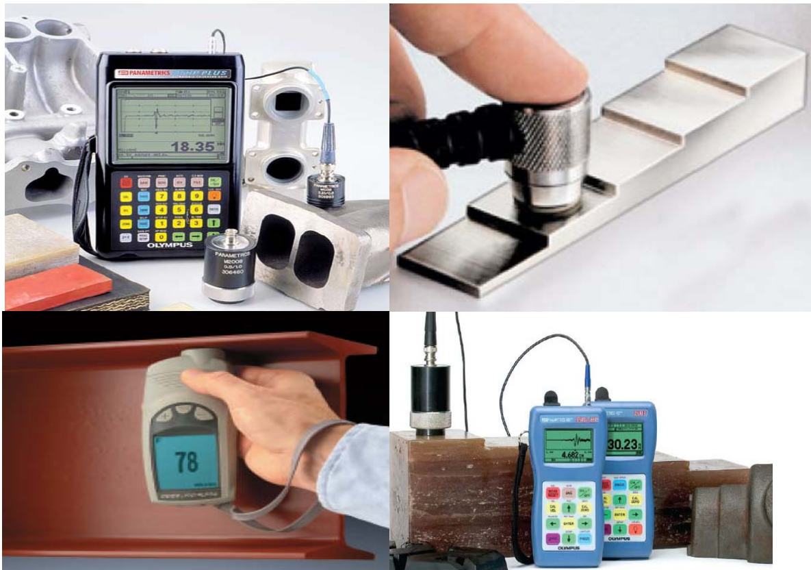
Figure I.3 : Mesure d'épaisseur par ondes ultrasonores de volume
