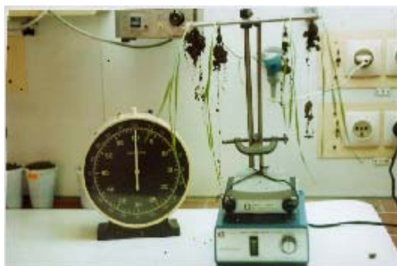
Photo 3. Dispositif permettant l'extraction du sol adhérent.
