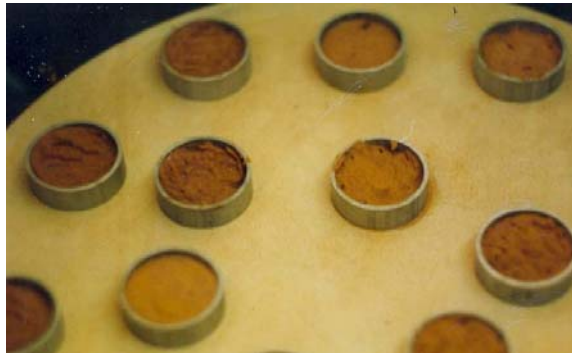
Photo 1. Mise en place des sols dans les anneaux et humectation pour la mesure de l'humidité équivalente à pF2,7.
