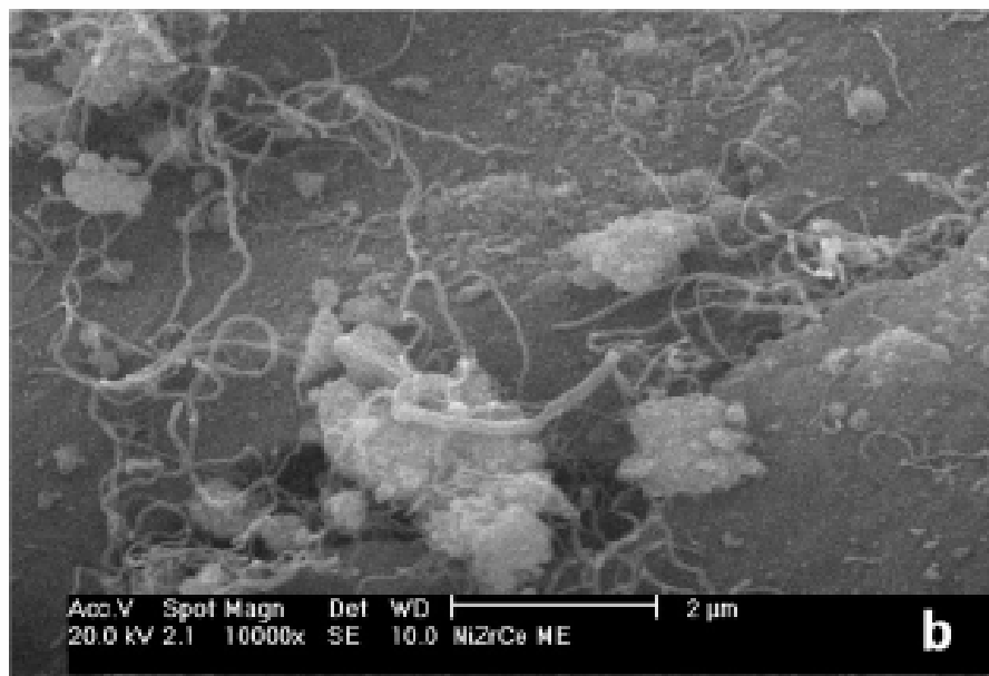
Figure 11 : Image MEB du catalyseur Ni/ Ce_{0.5}Zr_{0.5}O_2 après 24 heures sous mélange réactionnel dans le réacteur membranaire. (a) surface des particules catalytiques ; (b) détail d'une particule couverte de ZrO_2 contenant des nanofibres de carbone.
