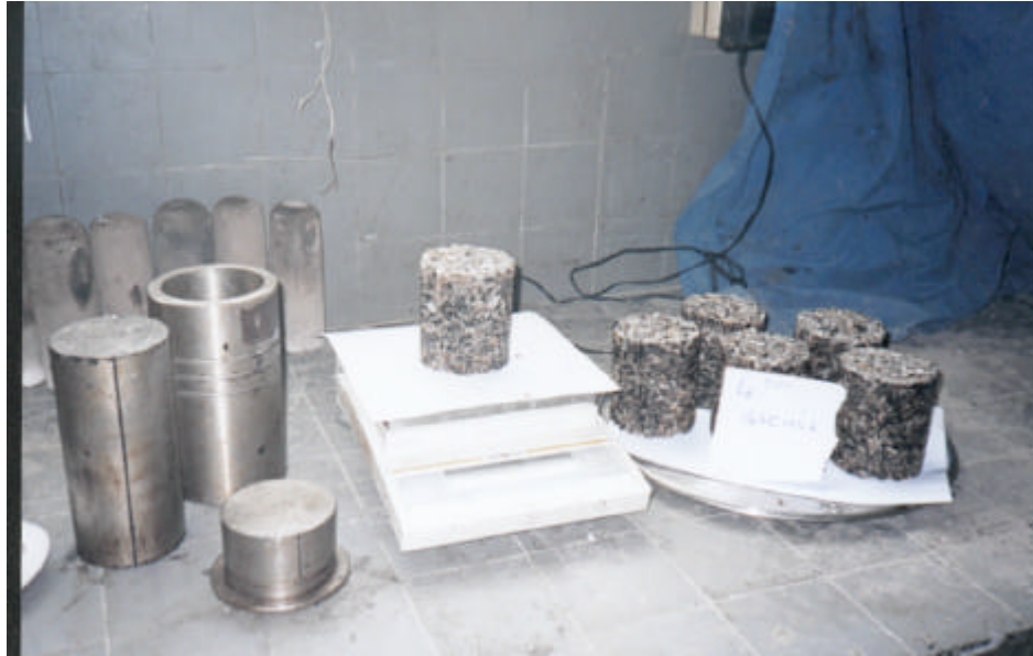
Fig VI.3 : Moule utilisé pour le confécionnement d'une éprouvette Duriez, avec un enrobé à froid
