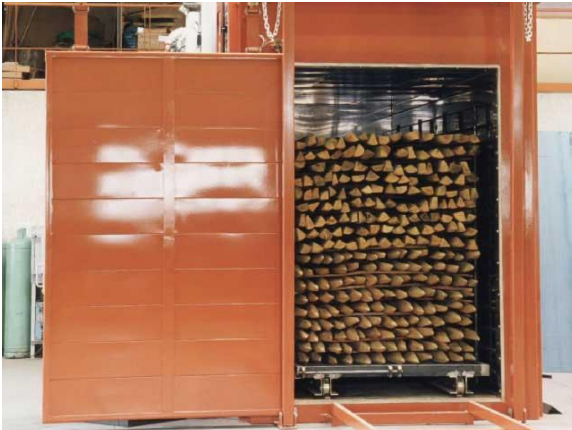
Figure I.7 : Photo d'un four de traitement du bois Perdure (source : PCI Industries Inc., http://www.perdure.com )
