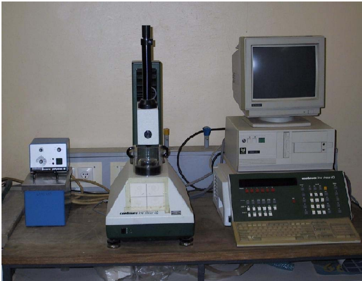
Figure III.8 : Viscosimètre Low Shear 40 avec ses auxiliaires d'acquisition et de thermostatisation
