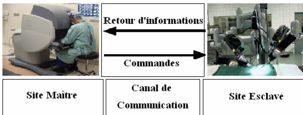
Fig.I.20 : illustration de l'architecture générale d'un système de téléopération.
