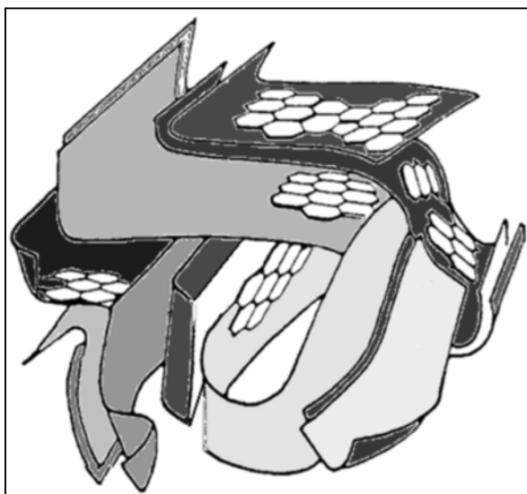
Figure I.3 : Représentation schématique de la microstructure du charbon actif [76].
