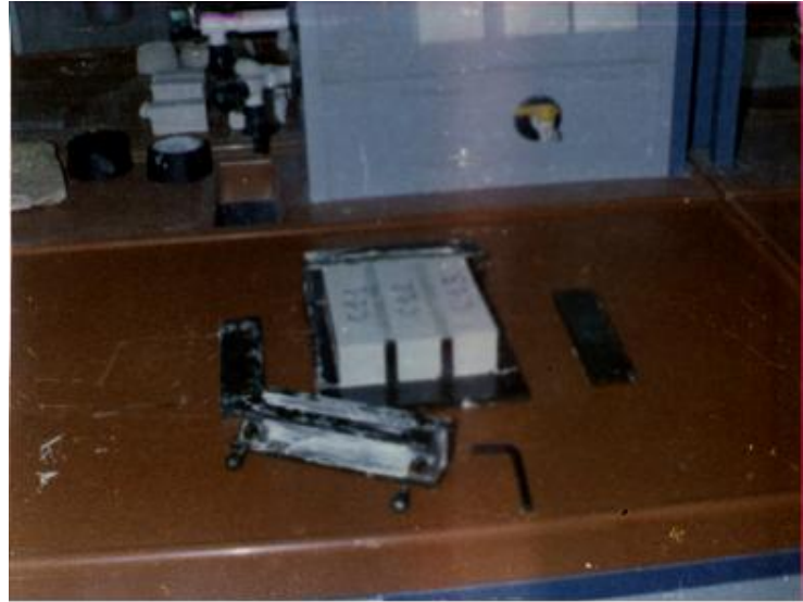
Figure IV.3 : Éprouvettes simplement coulées, après démoulage.
