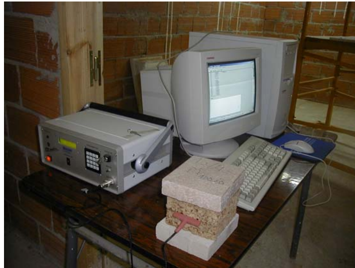
Figure IV.11: Image pendant la mesure avec CT mètre.
