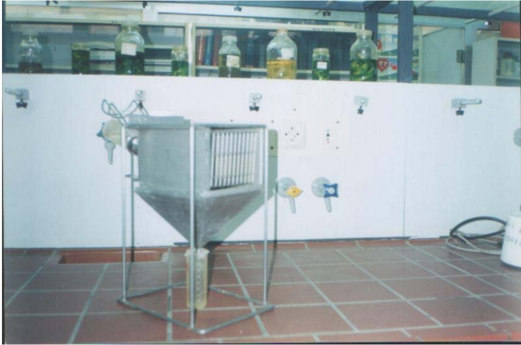
Photo 1 : Vue générale d'une cage métabolique pour rats utilisée pour le recueil des urines et feces de 24 h et le contrôle de la prise alimentaire.
