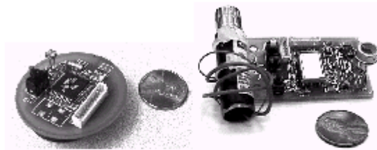
Figure 4. noeud capteur sans fil. sur la gauche un noeud radio-fréquence avec des capteurs de lumière et de température. sur la droite, un noeud laser avec des capteurs de température, pression, lumière et humidité.
