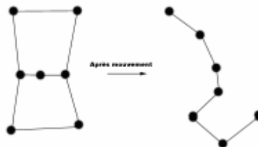
Figure 3. Changement de topologie dans les réseaux Ad Hoc
