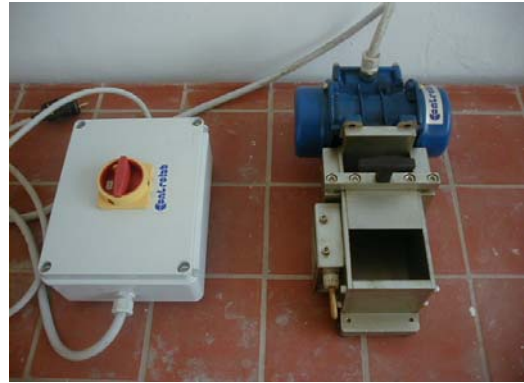
Photos 2 : Maniabilimètre à mortier LCPC
