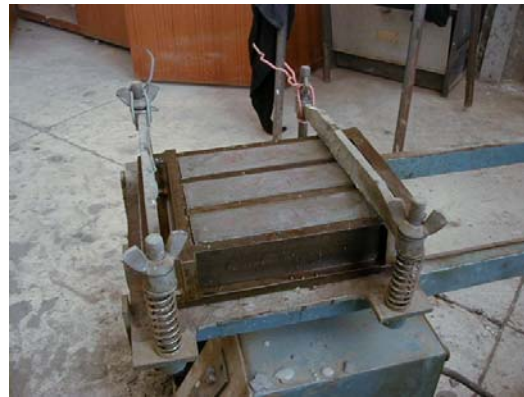
Photos 4 : Appareil pour le serrage des épreuves pour les BPR moules pour prismatiques de 4X4X16 cm
