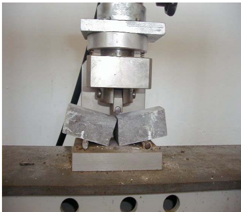
Photos.5 : Essais de traction par flexion sur des éprouvettes 4x4x16 cm
