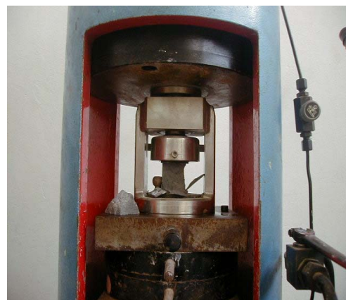
Photos.6 : Essais de compression sur des éprouvettes 4X4X16 cm
