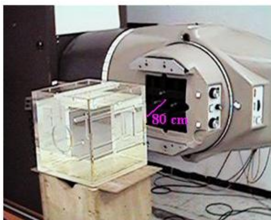
Figure 3.8. Dispositif expérimental dans le cas des photons (cas de ^{60}\text{Co} )
